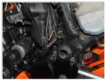
・車両左側、フレームカバー 下にある速度センサーの カプラー(黒3P)を分割 し、Alproのカプラーを割 り込ませます。
