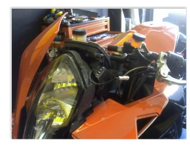
・車速センサーカプラーに AIproのカプラーを割り込ま せます。
