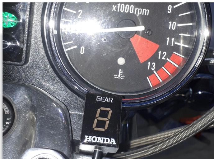
Tips : ①メーター後部の回転信号線はバイク全体に流れています。そちらを辿って配線探しすればより楽に結線できる場所が発見。
