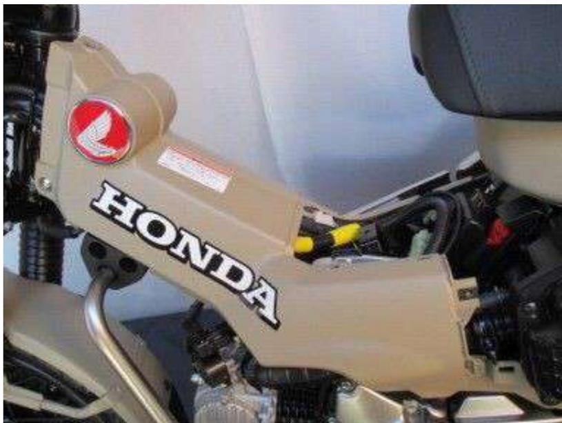
最初に カバー裏側にある 2ヶの樹脂クリップを外します。
