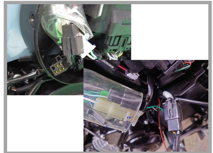
・ 分割した黒6PカプラーにAPHDの接続用ハーネスの6Pカプラーを確実に接続します。
